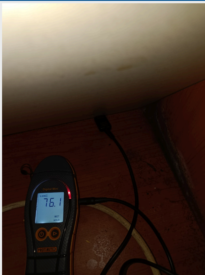
1.12 76,1% i frontvegg på bad nede ved blomsterbrettet. Her er det også mugg/sopp på sideveggen
